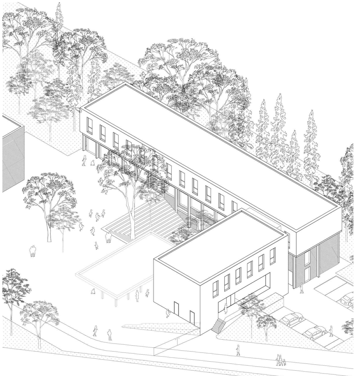
Axonometrie van de uitbreiding (wit gekleurd) op de bestaande basisschool (grijs gekleurd)
